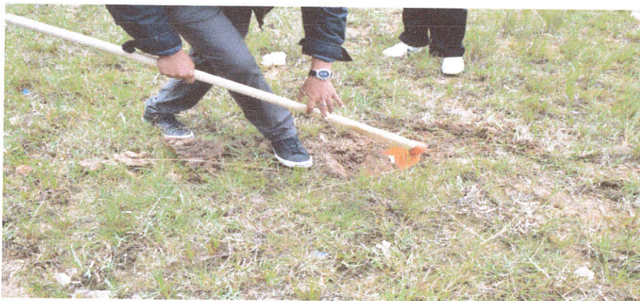
บรรยายภาพ:วิทยากรจากสถานีพัฒนาที่ดินนครศรีธรรมราชสาธิตการขุดดินนำไปทดสอบค่าPH และธาตุอาหาร
